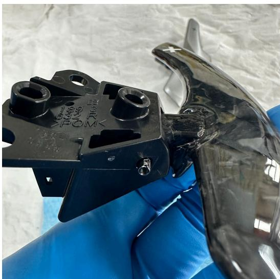
6.パドルをスイッチ部に戻し、接点を白い樹脂部品に正確に復元する。
