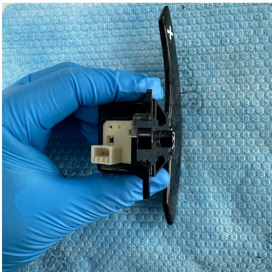
8.ステアリングにパドルシフターを戻し、クリック感が適切か確認する。
